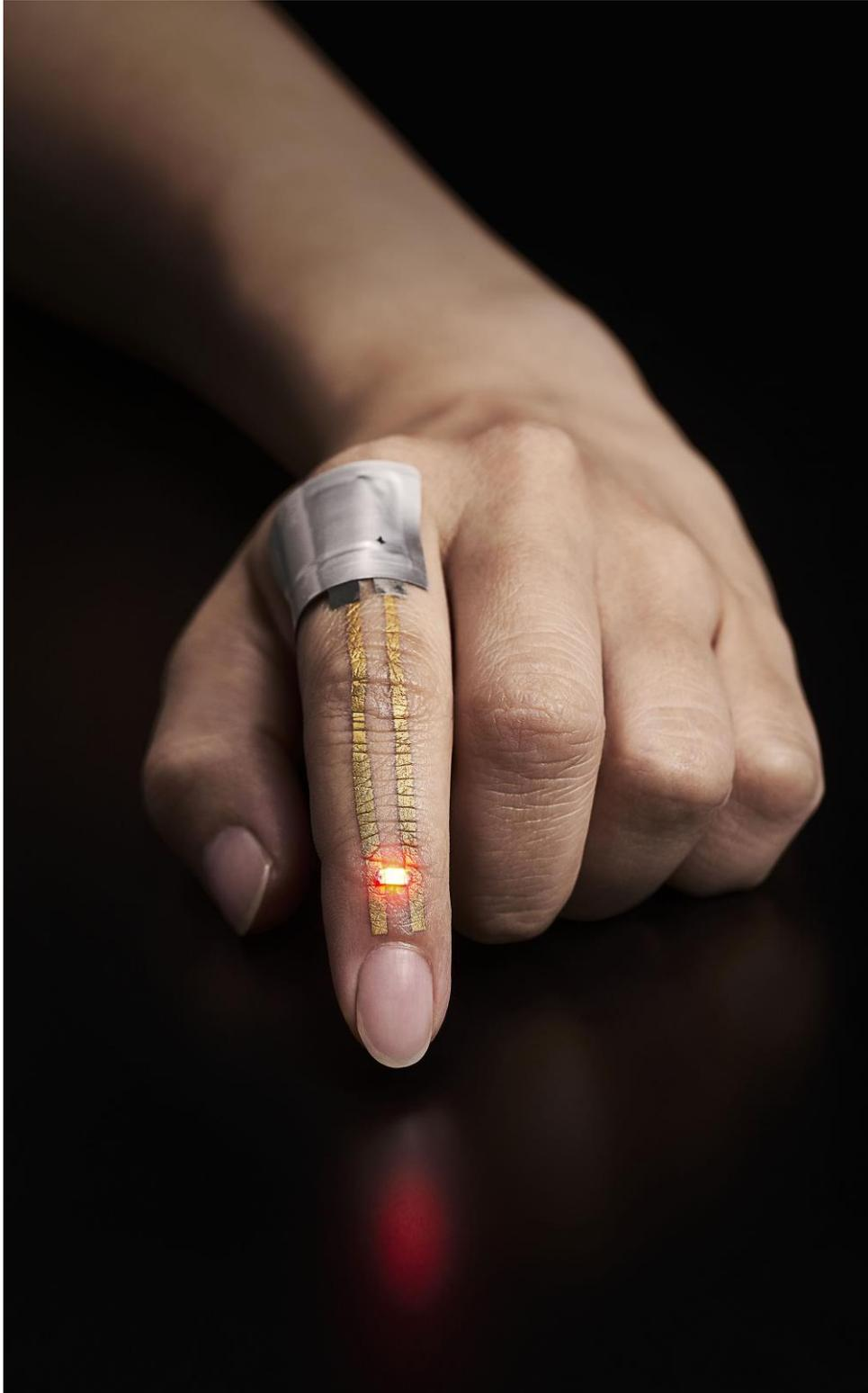
提供写真1 皮膚貼り付け型ナノメッシュ電極を人差し指に装着し、フレキシブルバッテリーから電力を供給して発光ダイオードを点灯させた。
