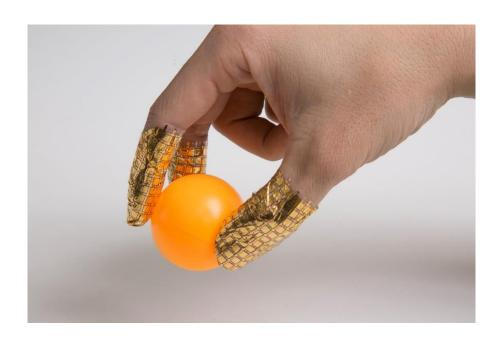
(図) 指に巻いたセンサーアレイ。非常にフレキシブルで曲面にもピッタリとフィットしま す。しわなどの変形があっても、精度良く圧力を計測できます。
