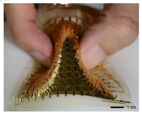
(図) 白い風船の上に、多点の圧力センサーのシートを密着させ、指で大きく変形させました。 このように大きく変形した状態でも、正確に圧力分布を計測することができます。なお、圧力センサーの素材は透明ですが、多点化したセンサーから圧力データーを読み出すための回路で使われている電極や配線は透明ではなく、金色に見えています。
